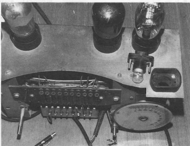
figura 6 – Particolare del telaio: il portalampeade e la lampadina che illumina la scala a numeretti.
