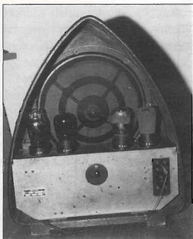
figura 3 Vista posteriore dell'apparecchio. Al centro del telaio il cambiotensioni.
